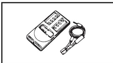
5. Comprobador de compresión del motor
